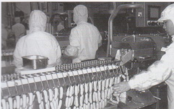
天然腸専用の「マックウェル」。最大で毎分800個の充填が可能
